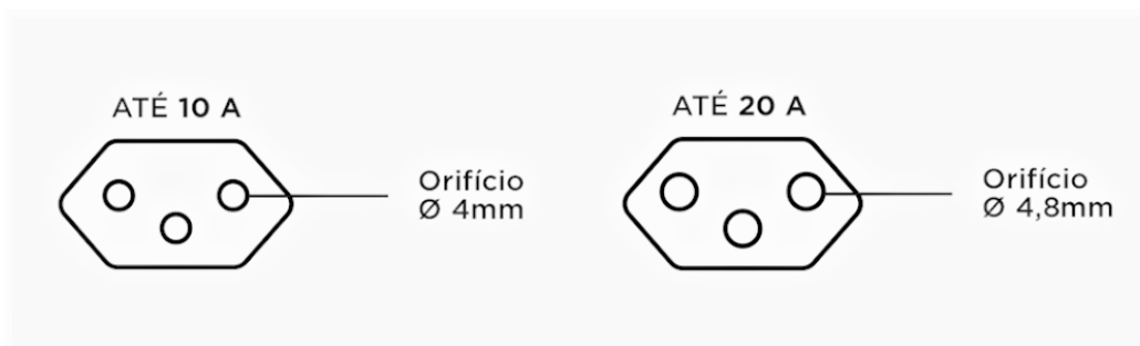
Figura 32 - Diferença no padrão das tomadas
