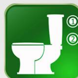
Bacia sanitária com válvula de descarga seletiva (3 ou 6 litros)
